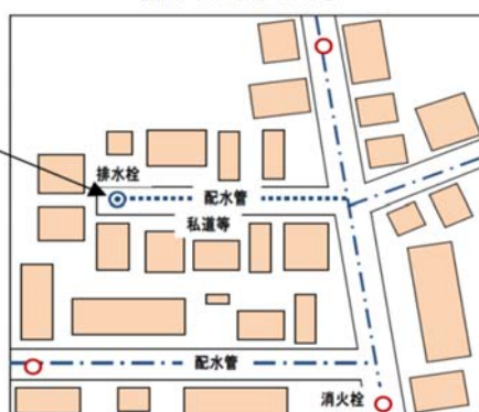
【排水栓の設置状況】
